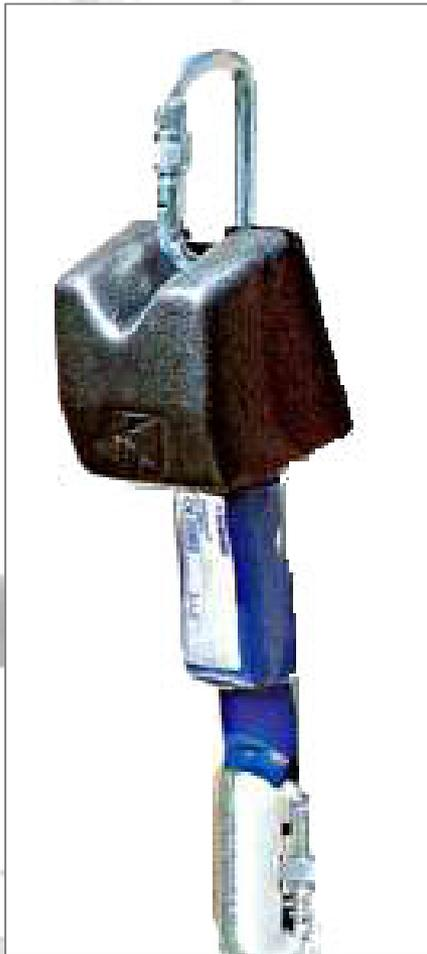
Dispositivo anticaduta dotato di funzione autobloccante e di sistema automatico di tensione e di ritorno del cordino, ovvero del cordino retrattile. Una funzione di dissipazione di energia può essere incorporata nel dispositivo stesso oppure un assorbitore di energia può essere incorporato nel cordino retrattile
