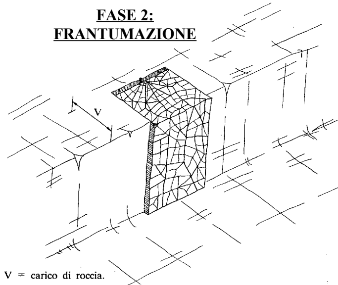
Fig. II.8 Schematizzazione del volume di roccia interessato dalla frantumazione per azione di una mina.
