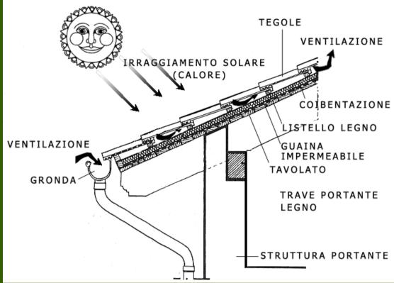
La ventilazione del tetto smaltisce il vapore acqueo degli interni che trasmiga verso l'esterno;
