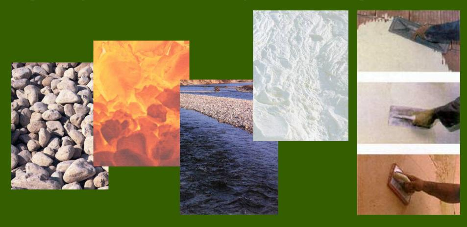
Il rivestimento a calce naturale presenta vantaggi rilevanti: è in grado di creare un tenace legame chimico, piuttosto che meccanico, con i blocchi di argilla, con l'effetto di una grande durabilità; ma soprattutto – diversamente dagli ntonaci premiscelati grazie alla grande capacità di assorbire e restituire umidità e ad una permeabilità al vapore prossima a quella del laterizio, presenta una elevata traspirabilità e valori minimi di ritenzione d'acqua.
