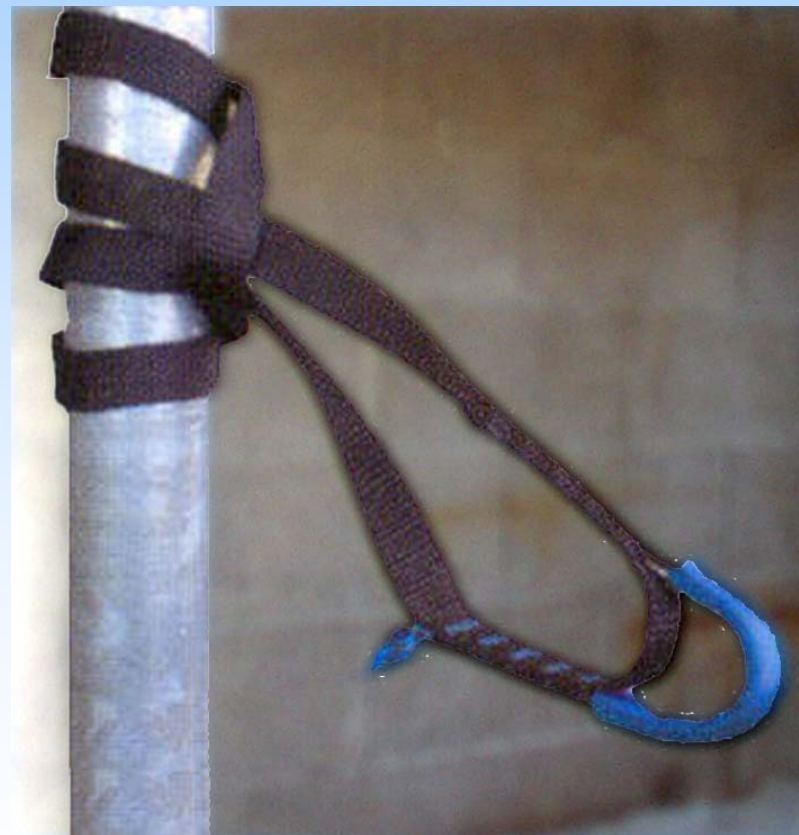
ANCORAGGIO A FETTUCCIA (come da progetto)
