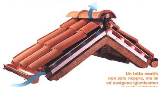
Un tetto ventilato non solo ricopre, ma isola ed ossigena igienicamente i luoghi dell'abitare.
