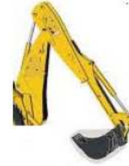
Escavatore : braccio con benna per scavo
