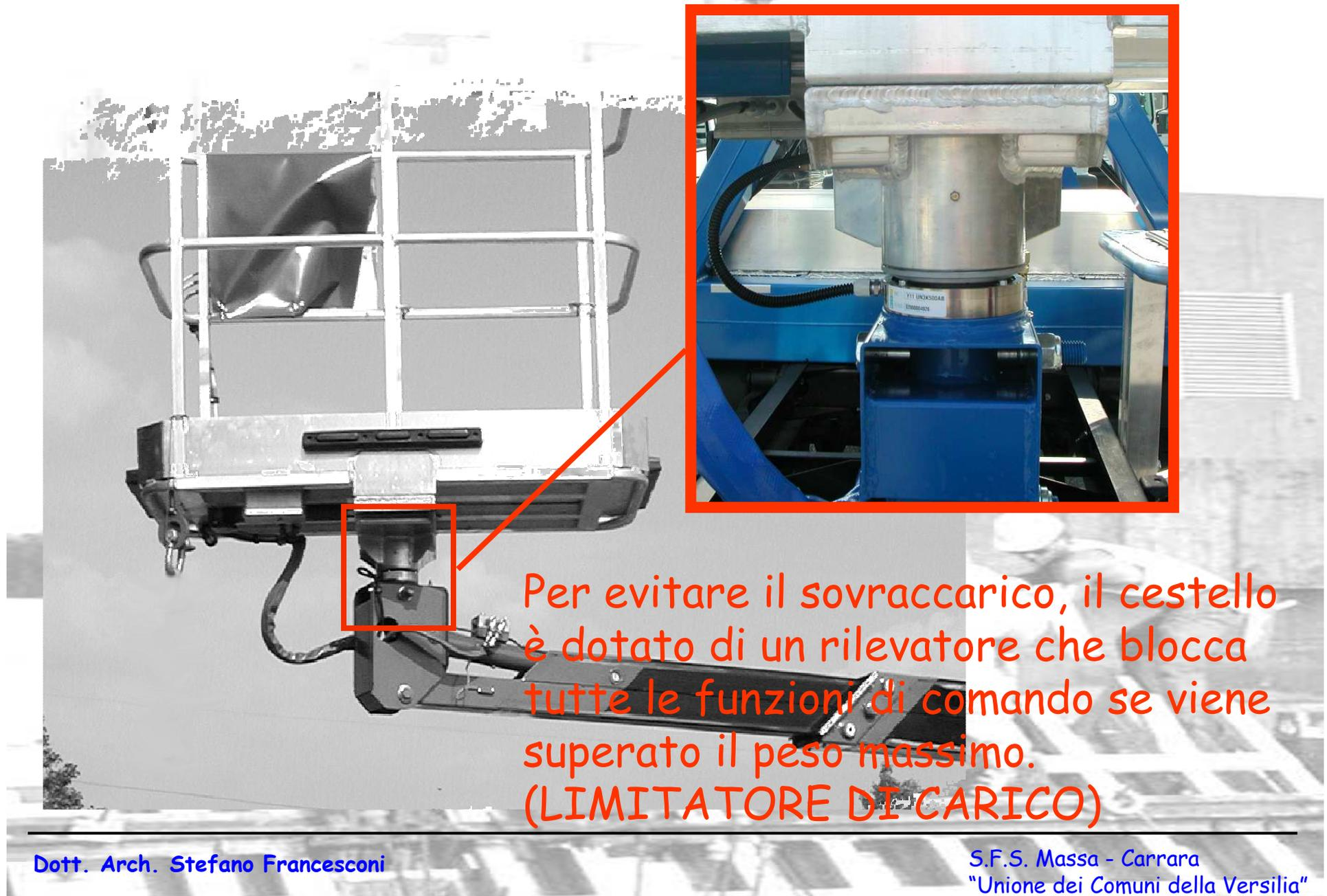
Per evitare il sovraccarico, il cestello è dotato di un rilevatore che blocca tutte le funzioni di comando se viene superato il peso massimo.
