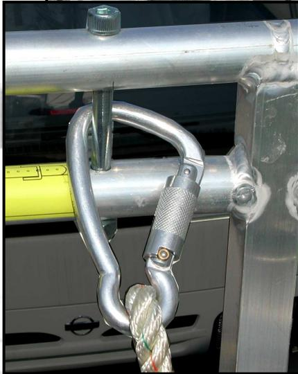
Il cestello, può essere in alluminio, metallo o vetroresina, deve disporre di pavimento antiscivolo e autodrenante, essere **protetto da un parapetto (h=1.10 m)** con arresto al piede **(h=0.15 m)** su tutti i lati **(non sono ammesse catenelle o funi)** e da un cancello apribile verso l'interno o scorrevole in senso verticale, con ritorno in chiusura. Devono essere presenti l'indicazione della **portata (n° persone + attrezzi)** e il punto di attacco per l'imbracatura.
