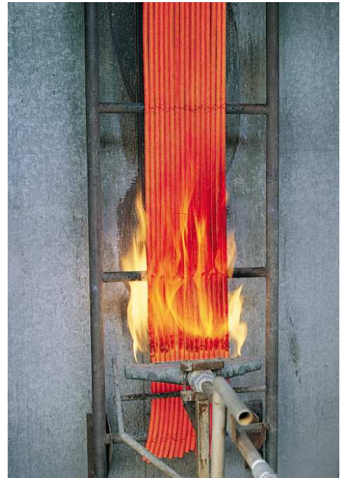
Figura 6.2: prova di propagazione alla fiamma
