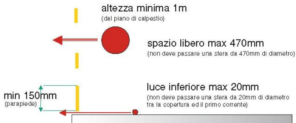
Parapetto classe A, saldamente ancorato alla struttura del fabbricato, con altezza di almeno 1 m misurato sulla perpendicolare alla superficie di lavoro.
